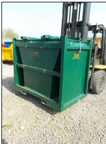
Exemples de GRV métalliques pour le transport de poudres
