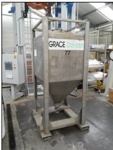
Exemples de GRV métalliques pour le transport de poudres
